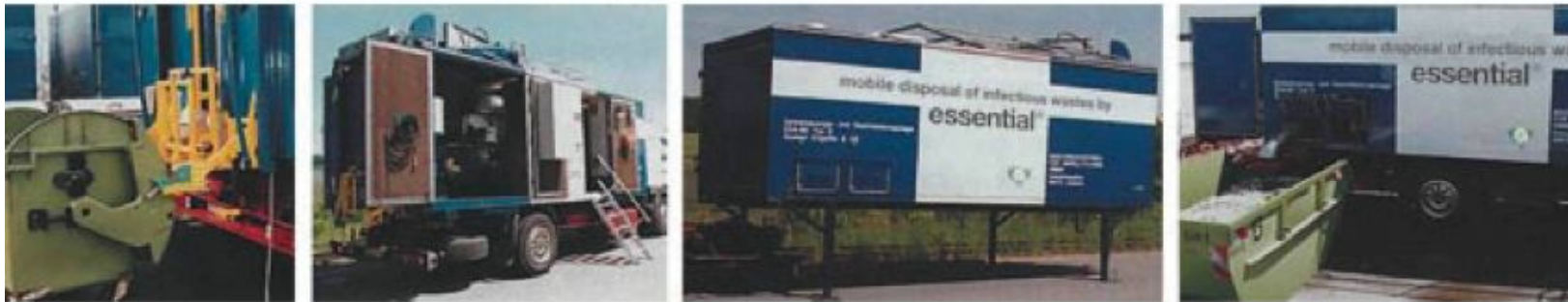
Подъемно-опрокидывающее устройство с весами - установка смонтирована на грузовом автомобиле - стационарный режим работы - выгрузка дезинфицированных и измельченных отходов.
